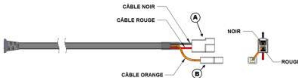
Branchez (A) à la batterie ou au système de 12V avec un des deux câbles de raccordement inclus. Rouge = plus (+) et noir = moins (-).
